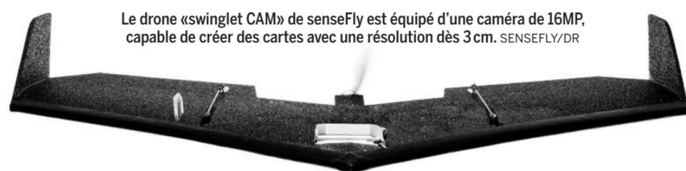
Le drone «swinglet CAM» de senseFly est équipé d'une caméra de 16MP, capable de créer des cartes avec une résolution dès 3 cm. SENSEFLY/DR
